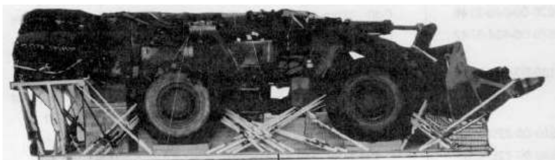
Figura 3-21 - Carregadora de Rodas preparada para lançamento a baixa velocidade
