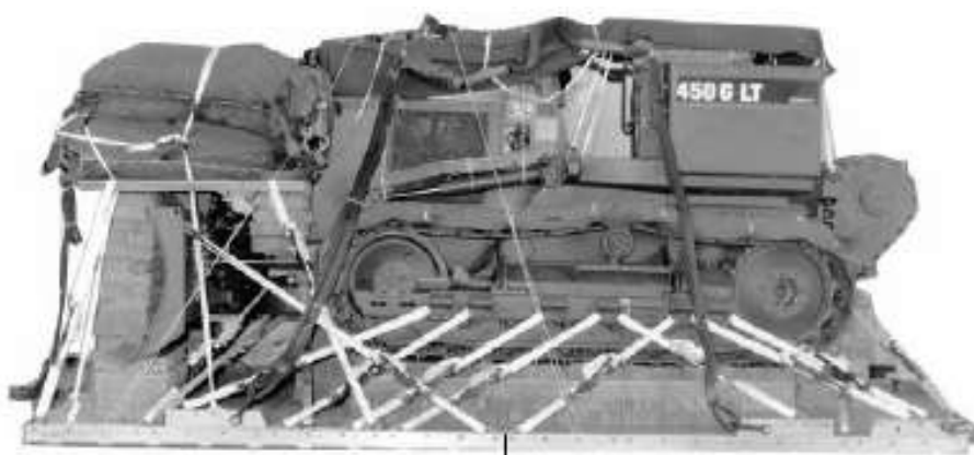
Figura 3-19 - Trator de Lagartas preparado para lançamento a baixa velocidade
