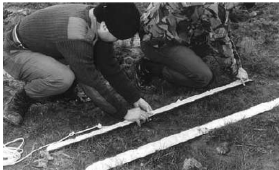
Figura 2-3 - Preparação de torpedo bengalório improvisado
