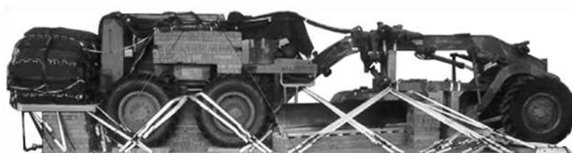
Figura 3-18 - Niveladora preparada para lançamento a baixa velocidade
